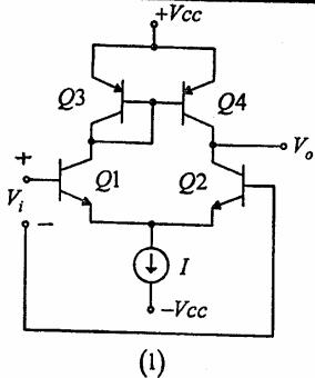
۵۸- بهر  $\frac{V_o}{V_i}$  در مدارهای روپروچه رابطه‌ای با هم دارند. در شکل ۱:  $\frac{V_o}{V_i} = AV_1 : 2$  و در شکل ۲:  $\frac{V_o}{V_i} = AV_1$
