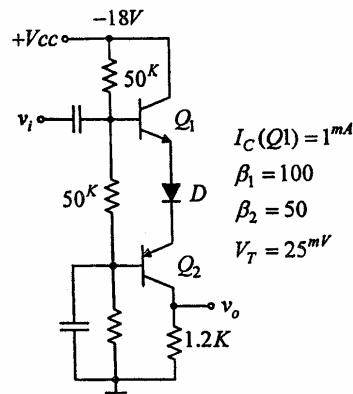
۵۲ - مقدار جریان  $I_o$  در مدار شکل رویه روبرو به کدام گزینه نزدیکتر است؟ ( $V_{BE} = 0.5V, \beta \rightarrow \infty$ )
