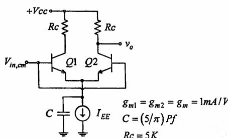
۵۷- برای مدار مقابل بهره و لذت و مقاومت خروجی تقریباً برابر است با:  $g_{m1} = 2mV, r_{e1} = 5\Omega, h_{fe} = \beta = 100$
