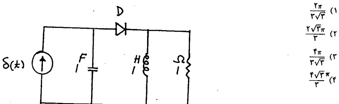
۵۳- در مدار در حالت دائمی سینوسی زیر ماکریم توان  $N$  برابر  $\frac{1}{\lambda}$  وات است. آنگاه:
