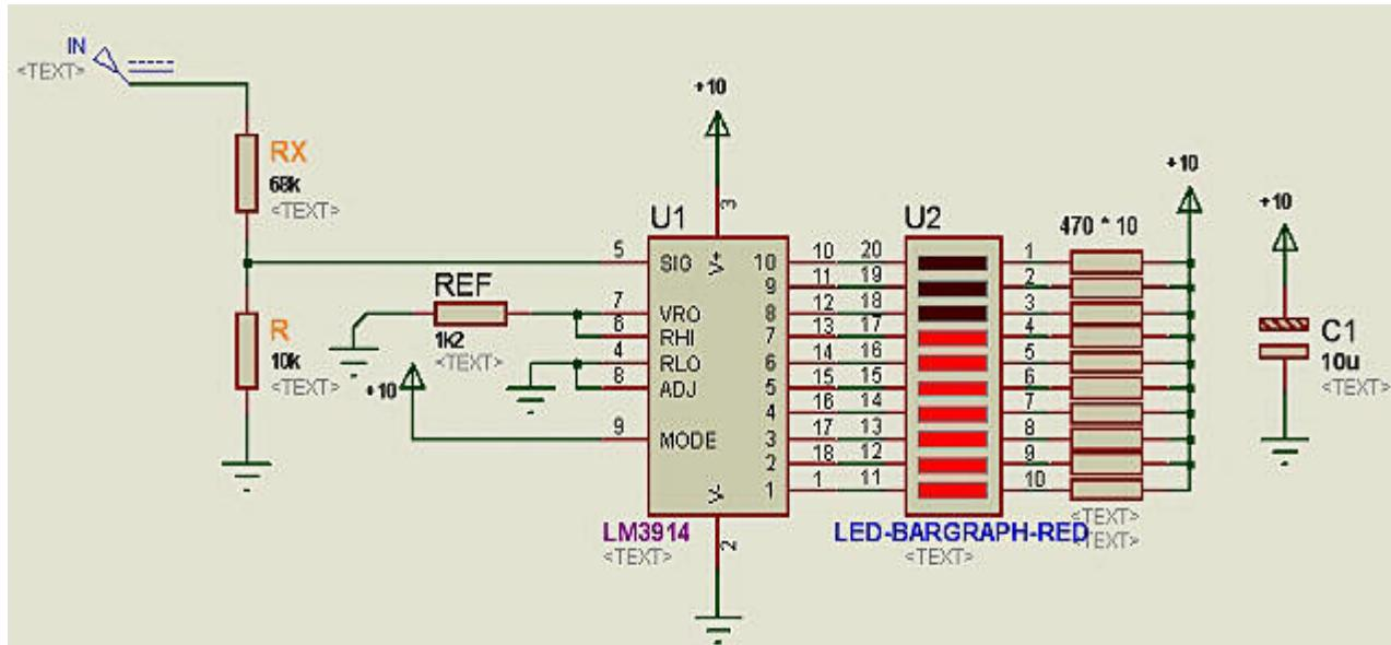
در این مثال قرار است ساخت یک مدار جالب به کمک IC معروف LM3914 تولید شده توسط شرکت National Semiconductors را با هم تجربه کنیم.
