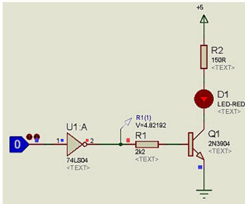
قطعه logic state نمایانگر خروجی دیجیتال می باشد در واقع یک منبع تولید کننده 1 و 0 منطقی است. در این مدار ساده ، ترانزیستور مانند یک کلید on و off (اشباع و قطع) عمل می کند.
