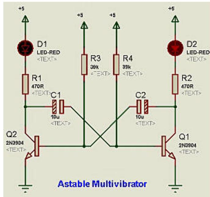
مداری که در بالا ملاحظه می کنید یک نوسان ساز ناپایدار است که به محض RUN نمودن مدار LED ها یکی در میان شروع به خاموش و روشن شدن می کنند . چگونگی عملکرد مدار و محاسبه فرکانس نوسان را می توانید از کتابهای تکنیک پالس مطالعه بفرمائید که بسیار ساده می باشد اما توضیح آن در این مقاله که سعی شده مطالب آموزشی آن تا آنجا که امکان دارد کوتاه و مختصر گفته شود ، شاید چندان مناسب نباشد.
