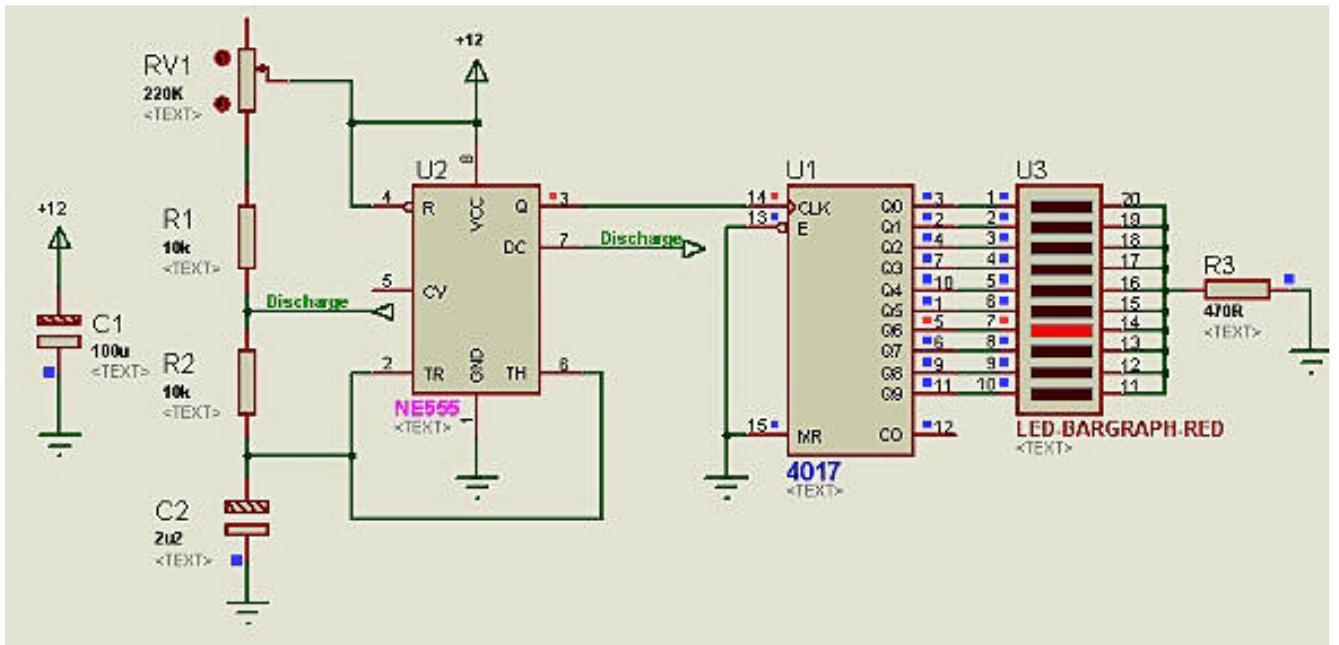
مدار بالا یک مدار جالب در زمینه optoelectronics می باشد که به کمک IC CMOS 4017 معروف است. 4017 یک نوع مدار مجتمع Counter/Devider ده تایی ساعت دار می باشد که 10 می باشد طراحی شده است. خروجی pull up کاملاً رمزگشایی شده دارد که هر کدام از آنها می تواند یک LED را براحتی راه اندازی کند همچنین این IC در محدوده 3 تا 15 ولت تغذیه می شود و بیشتر در مدارهایی که نیاز به تقسیم فرکانس است دیده می شود.
