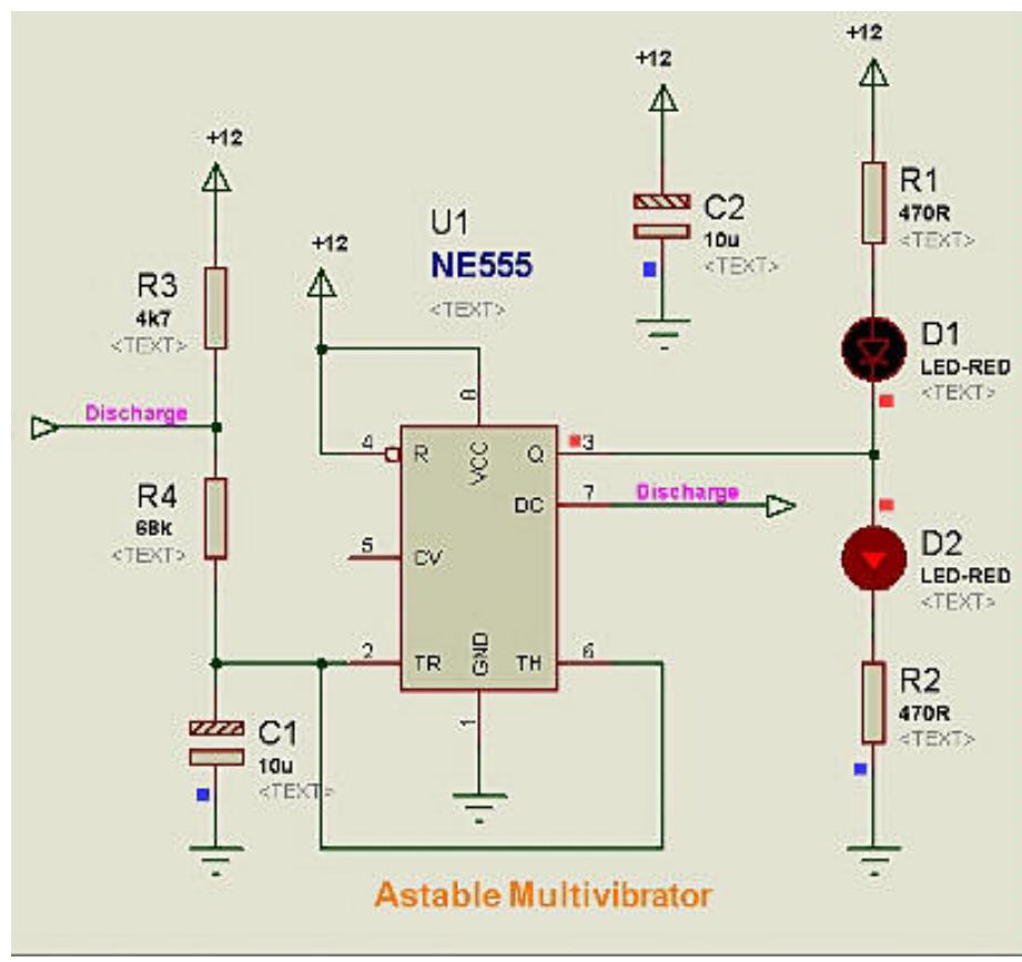
مداری که ملاحظه می کنید یک نوسان ساز ناپایدار است که به کمک IC معروف 555 طراحی شده است خروجی این مدار تقریباً با فرکانس 1 Hz از پایه 3 آن گرفته شده و به شاخه ای شامل دو عدد LED داده شده است لذا در این مدار LED ها متناوباً با فرکانس 1 هرتز (یعنی در هر 1 ثانیه یکبار) خاموش یا روشن می شوند. فرکانس نوسان این مدار به مقادیر R3,R4,C بستگی دارد و طبق فرمول زیر قابل محاسبه است:
