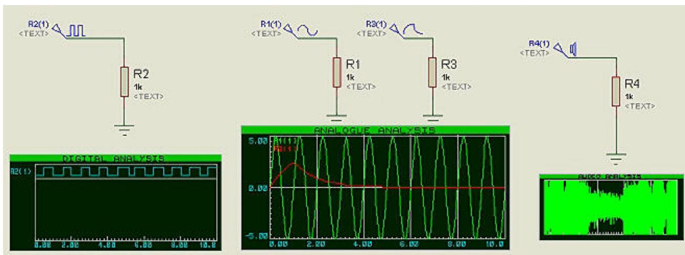
در اینجا خروجیهای 4 منبع سیگنال نمایش داده شده است. در شکل وسط ، دو سیگنال بطور همزمان به نمایش در آمده اند زیرا نوع هر دو سیگنال شبیه به هم است یعنی هر دو از نوع آنالوگ هستند اما شکل اول نمایش یک سیگنال صوتی و شکل سوم نمایش یک سیگنال دیجیتال می باشد و چون نوع تحلیل آنها متفاوت است لذا در پنجره های مختلفی به نمایش در آمده اند.
