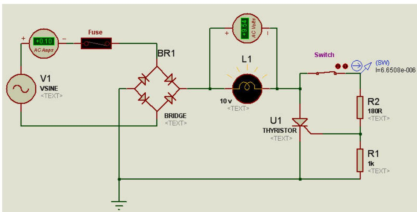
همانطورکه از نام تریستور برمی آید ، این قطعه نوعی یکسوساز سه پایه است که می توان عملکرد آن را از طریق پایه Gate کنترل نمود. این قطعه در حالت معمول بصورت کلید باز(قطع) می باشد. اما درصورتیکه آند به ولتاژ مثبت و کاتد به ولتاژ منفی متصل باشد ، می توان آن را طوری فعال کرد که بصورت دیود یکسوساز در بایاس مستقیم عمل کند. برای اینکار باید جریان تحریک اندکی به پایه Gate اعمال شود.
