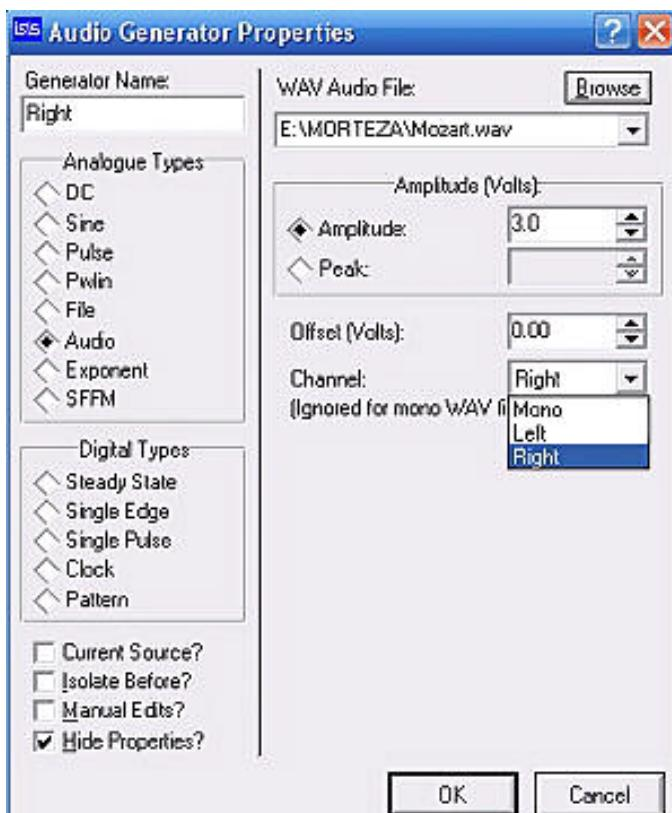
برای تنظیم پارامترهای این منبع کافیست که یکبار بر روی آن کلیک راست کرده تا به رنگ قرمز درآید و یا اصطلاحاً select شود سپس بار دیگر بر روی آن کلیک چپ نموده تا پنجره مشخصات آن طبق شکل روی رو بازشود.
