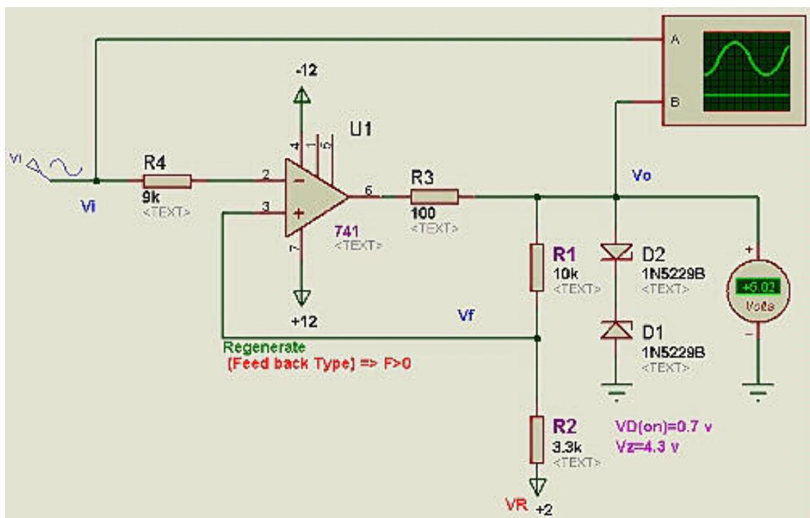
مداری که در بالا ملاحظه می فرمائید یکی از مدارهای معروف تولیدکننده Schmitt trigger می باشد که احتمالاً در کتابهای تکنیک پالس به آن برخورد کرده اید . تحلیل این مدار بسیار ساده و قابل فهم می باشد لذا در اینجا قصد دارم کمی در مورد نحوه عملکرد آن به شکل تئوری بحث کنم که امیدوارم برای شما جالب باشد.
