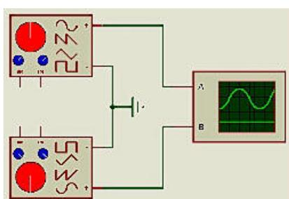
همانطور که در شکل روی ملاحظه می کنید خروجی های دو سیگنال ژنراتور به ورودی های کanal A و B جهت نمایش شکل موج آنها، وصل شده اند.
