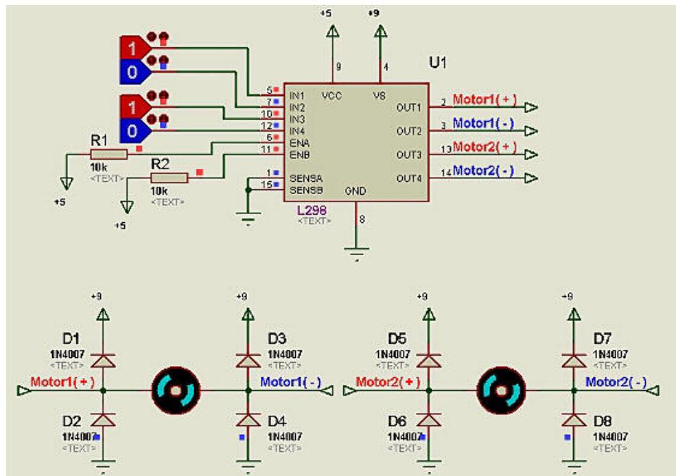
برای راه اندازی و کنترل موتورهای DC مدارهای زیادی وجود دارد اما در اینجا سعی کردیم ام تا از L298 که اکثر مهندسین الکترونیک با آن آشنا هستند استفاده کنم لذا در ادامه با برخی ویژگیهای این IC آشنا خواهیم شد.
