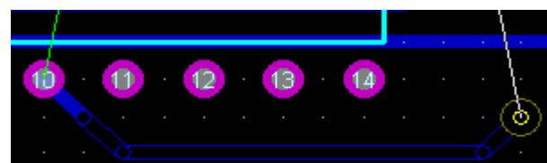
در صورتی که مسیری جلو شماست در یک مکان مناسب (منظور از مکان مناسب جایی است که در مسیر جامپر قطعه یا چیزی نباشد ، همچنین پایه جامپر به خطوط دیگر برخورد نکند و...) دوبار کلیک راست کنید تا بتوانید یک جامپر بزنید :
