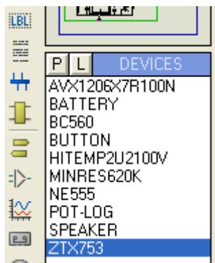
اکنون قطعات را در مکان مناسب بچینید ، برای اوردن قطعات ، در قسمت Device بر روی انها یک بار کلیک کنید( دقت کنید گزینه
