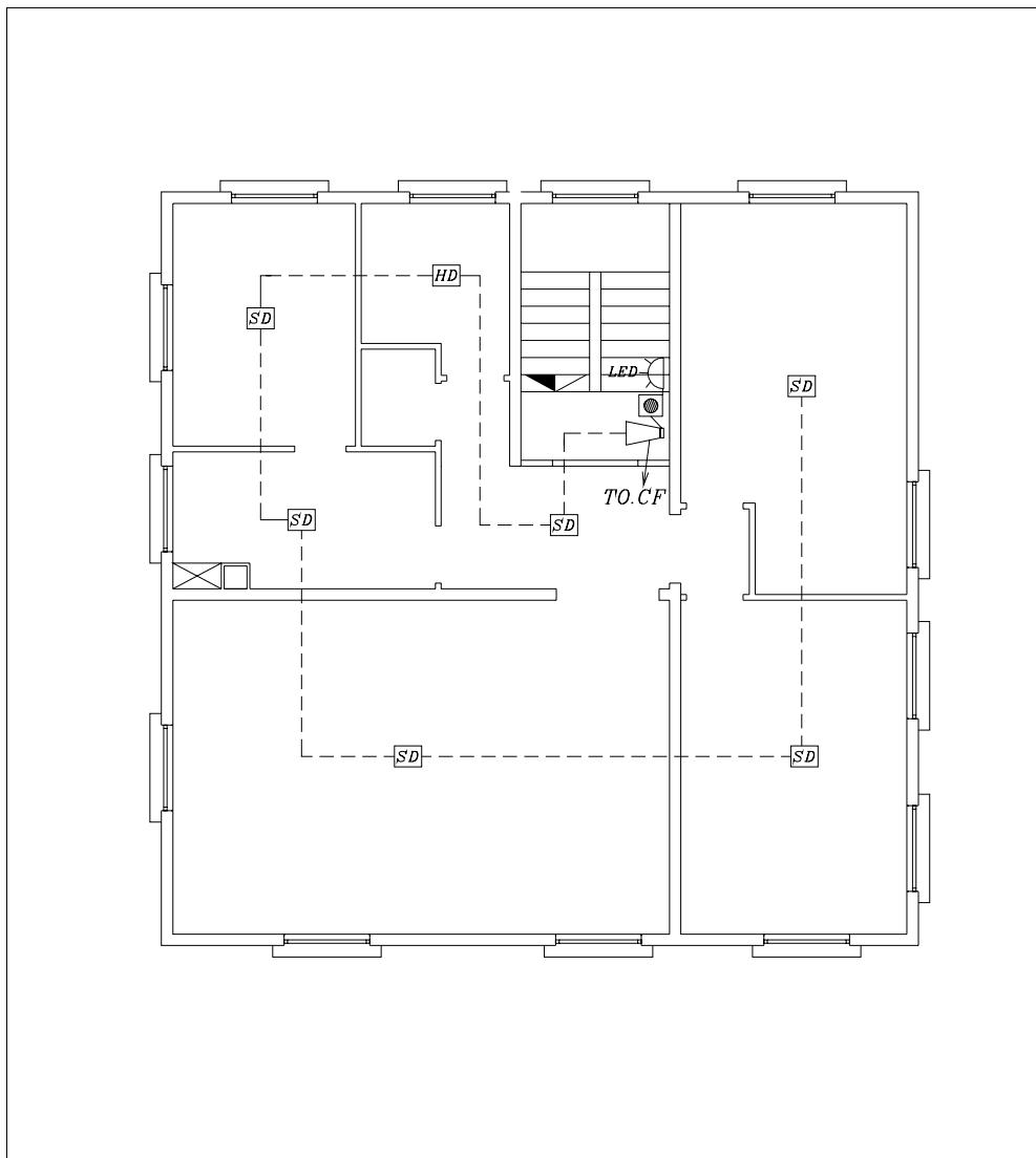
پلان تجهیزات الکتریکی طبقه اول (اعلام حریق و شستی زنگ اخبار)<sup>۱</sup>
